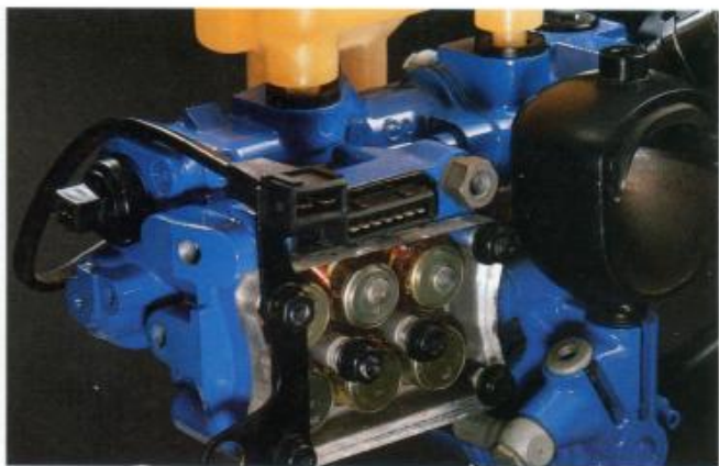
Die Hydraulikeinheit: Das Antiblockiersystem ist als Drei-Kanal-System ausgelegt. Die Hydraulikeinheit regelt den Bremsdruck für jedes Vorderrad einzeln. Der Bremsdruck für die Hinterräder wird gemeinsam geregelt.
