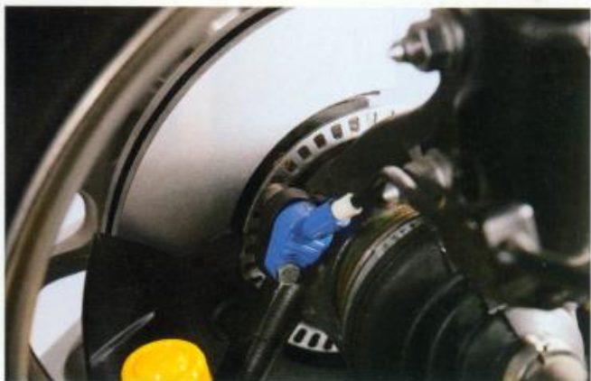
Von den Drehzahlfühlern gehen laufend Drehzahlinformationen an das Steuergerät. Besteht die Gefahr des Blockierens, gehen Stellbefehle vom Steuergerät an die Hydraulikeinheit. In der Hydraulikeinheit wird durch Stellbefehle an die Magnetventile der Bremsdruck an der Vorderachse für jedes Rad einzeln geregelt, an der Hinterachse für beide Räder gemeinsam.
